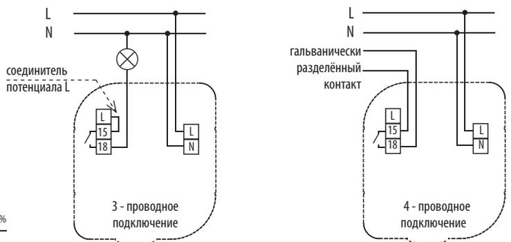
Устройство поставляется с соединителем L-15 (3-проводное подключение).
